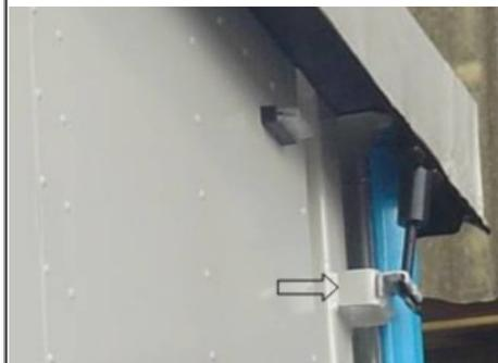
Con el cayado, destranque el mecanismo del sombrero por el lado interno de la lona del techo, conforme indicado, para levantar el sombrero.
