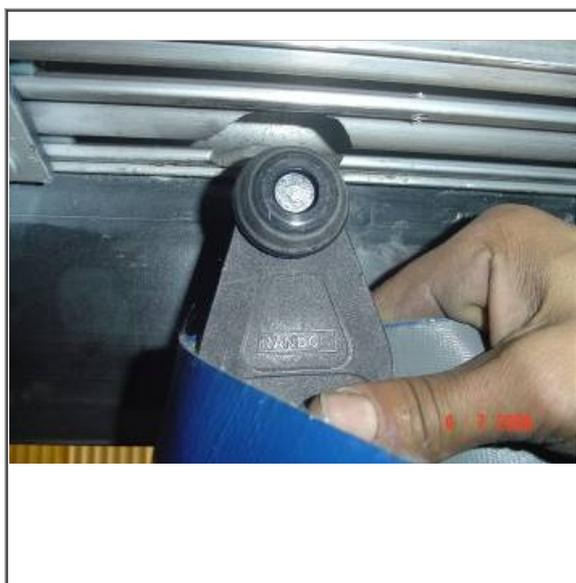
Para la mantención de los rodillos de la cortina lateral, ésta deberá ser movida hasta alcanzar la pieza que será sustituida, lo que será hecho por el agujero que está en la extremidad trasera del riel del techo.
