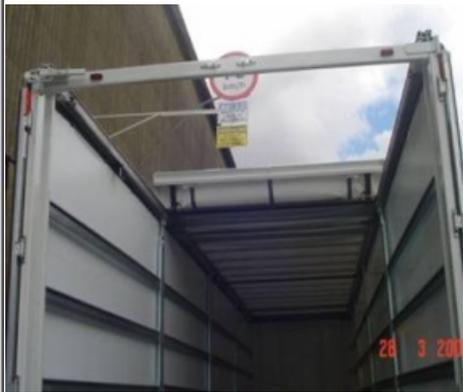
Solamente después de la liberación de estos mecanismos la lona del techo podrá ser movida de la trasera para la delantera del producto o viceversa.
