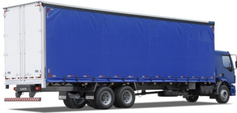
Randon S.A Implementos y Participaciones presenta su línea de cajas de carga modelo Sider. Se trata de una línea completa de soluciones para el transporte de cargas paletizadas y otras adecuadas, por las características de su embalaje o acondicionamiento al transporte, con amarras en la base tipo plataforma, como: bebidas, racks, bolsas, cajas, etc.
