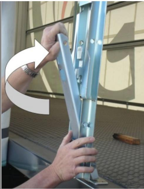
Para colocarla en el lugar se debe encajar el enganche en la base fijada en el perfil lateral del sider y presionar la columna contra el gatillo, trabando la misma automáticamente.
