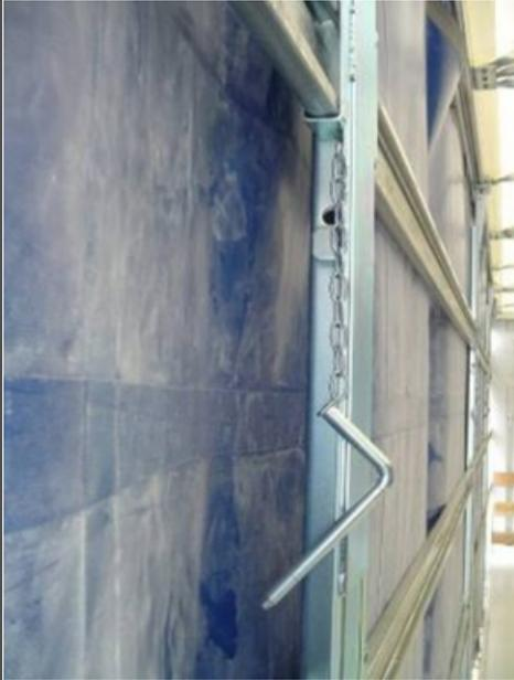
Para levantar el techo, primero deje todas las columnas móviles libres, conforme la figura.
