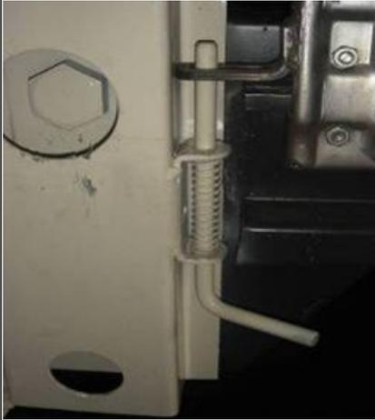
Tranca del conjunto total sider (lona con coches de arcos), para mantenerlos presos en las extremidades de la delantera y de la trasera.
