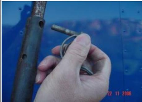
Estire el cayado, conforme el tamaño deseado y fjelo con el encaje del perno, conforme la figura.
