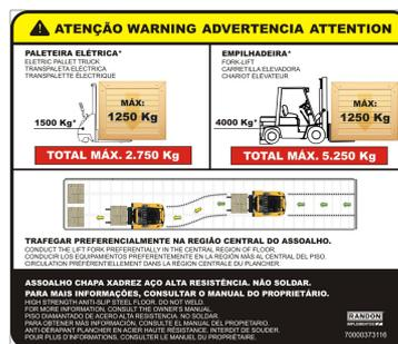
Para maximizar la vida útil del piso en productos con operación de montacargas y transpaletas, preferiblemente viaje sobre la región central del piso con las ruedas del equipo en los miembros laterales del chasis.
