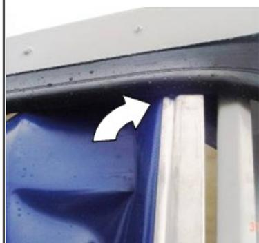
Para fijar la cortina lateral en el perfil delantero, encaje la parte superior por abajo del bando (protector lateral), jalándolo para el frente, en el sentido del estirador.
