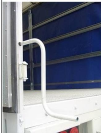
Para operar la parte trasera, las puertas deben estar completamente abiertas, conforme la figura.
