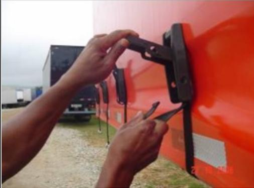
Después de estirar la cinta, dóblela para dentro, conforme figura.
