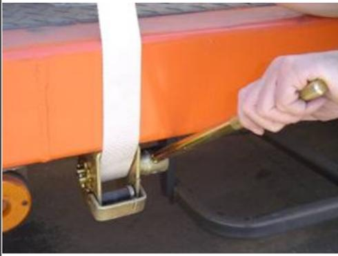
Estire las cintas con el propio cabo, conforme figura, de forma alternada y gradual las de la misma ala, evitando estirar totalmente una para después la otra. Gire para abajo.
