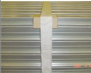
Proteja las aristas o esquinas vivas que puedan dañar o cortar las cintas, y páselas sobre la carga hasta alcanzar la triquete, conforme muestra la figura.
